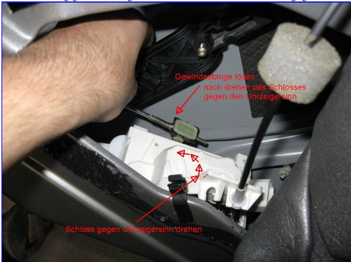
Zur Erklärung: Die Gewindestange hat auf der Rückseite diesen Plastikverschluss der 90 Grad zum Schloss einrastet und festgehalten wird.
