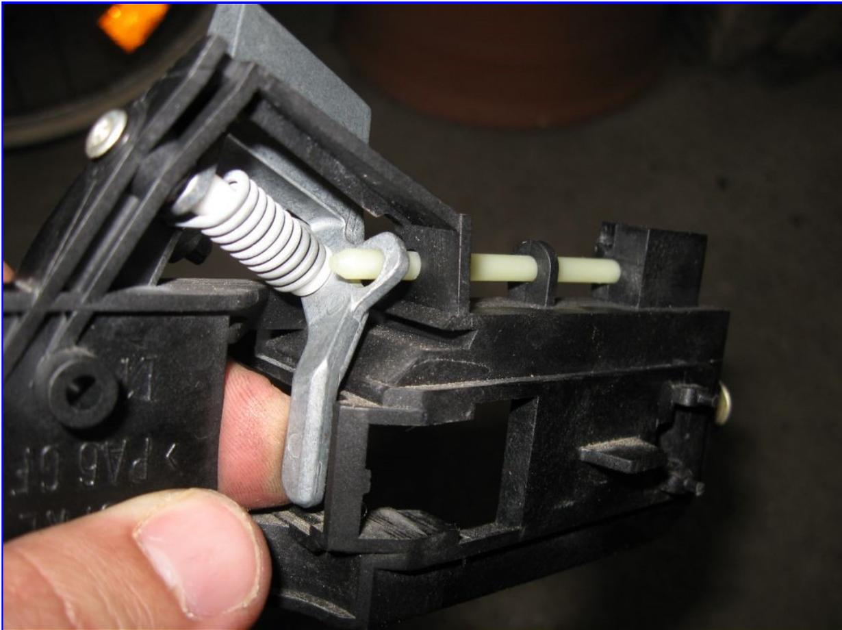
Beim Einbauen der inneren Griffhalterung muss darauf geachtet werden, dass die beide schwarzen Noppen durch die Blechöffnung herauschauen.
