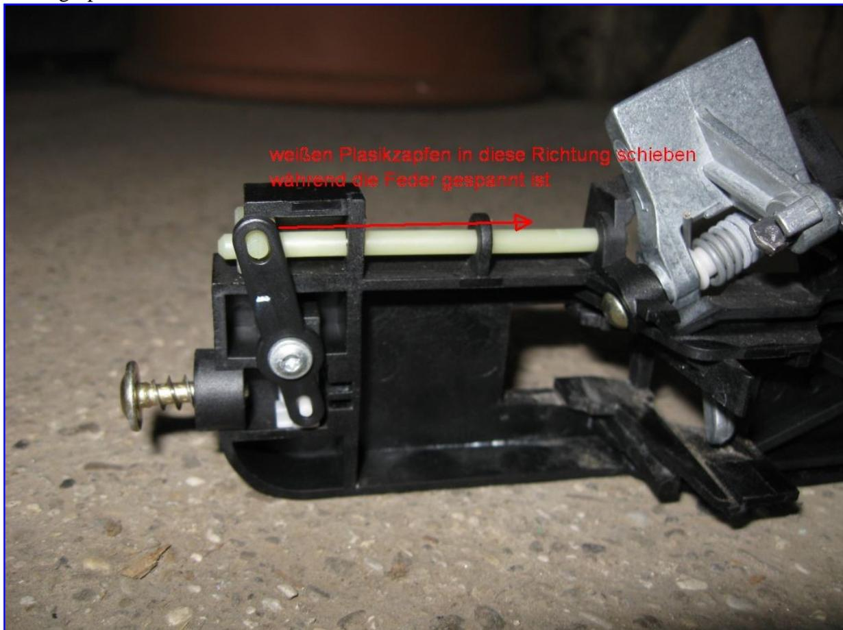
So sollte der Plastikzapfen dann eingerastet sein - er sollte aber nicht soweit hineingeschoben werden wie hier gezeigt, sondern nur gerade soweit, dass die Feder hält.
