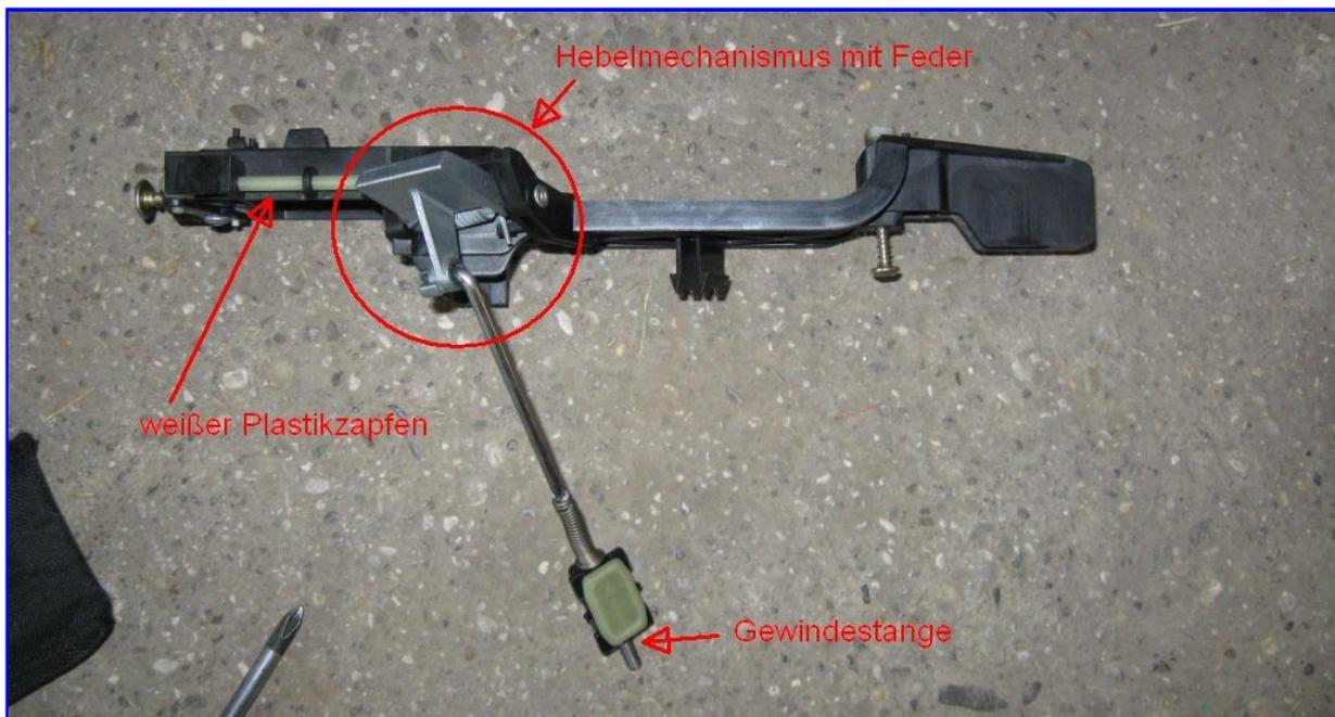
Dies wird enorm durch einen kleinen weißen Plastikzapfen erleichtert, der das erledigt.
