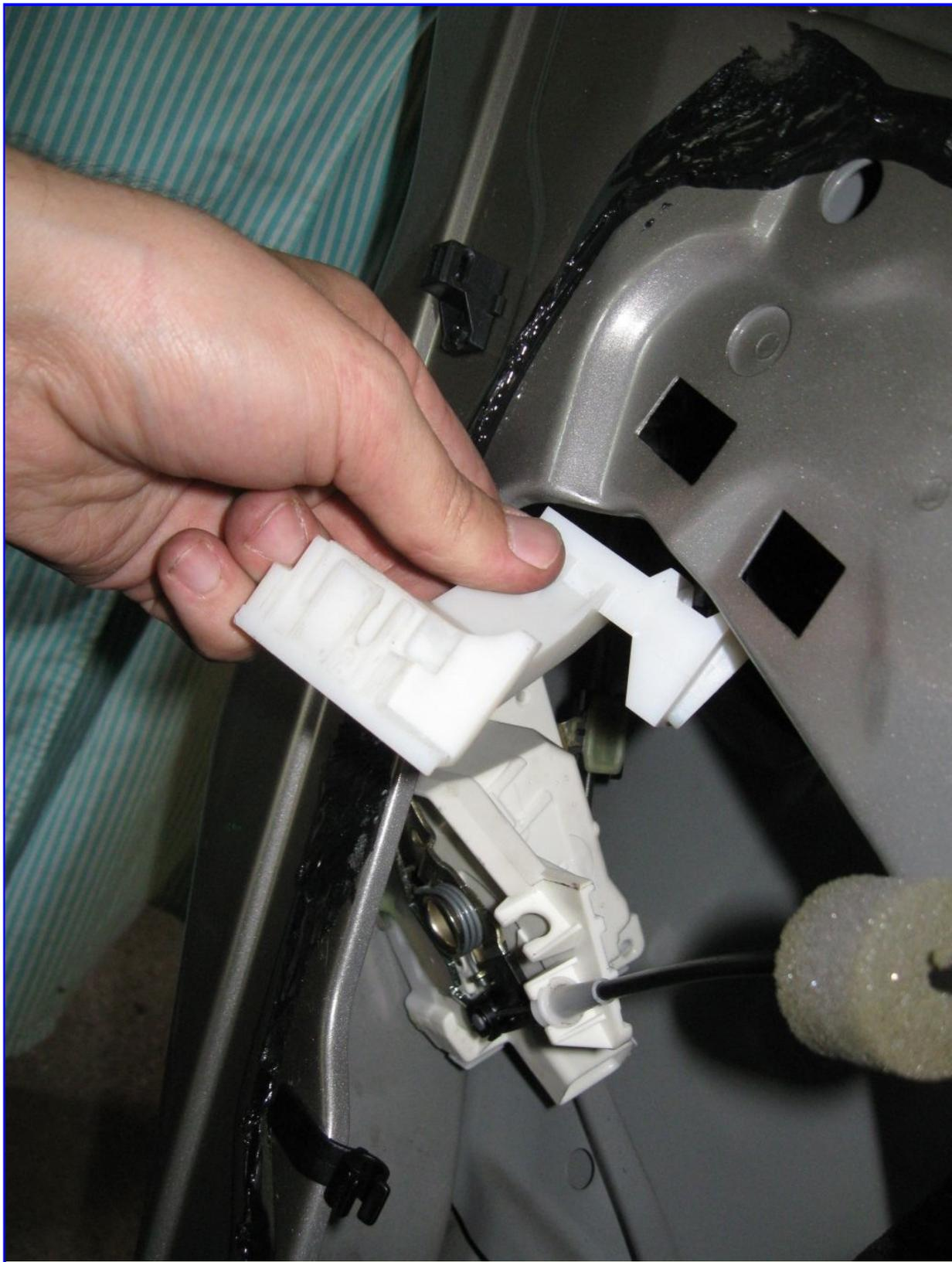
Die Griffhalterung von innen lösen. Hierzu die Torx-Schraube lockern (muss nicht ganz herausgedreht werden).
